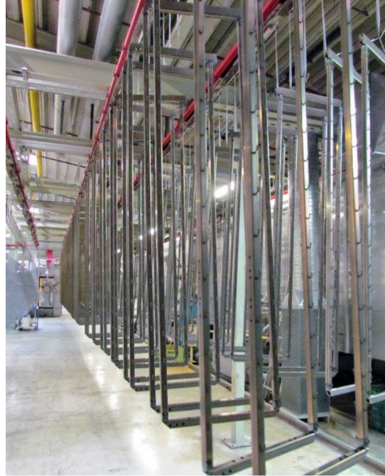
Blick in die Vorbehandlungsanlage bei Kesseböhmer: Die Vorteile des optimierten Vorbehandlungsprozesses sind verbesserte Lackhaftung, geringerer Schlamm- anfall und Energie sparende Arbeitstemperatur.
