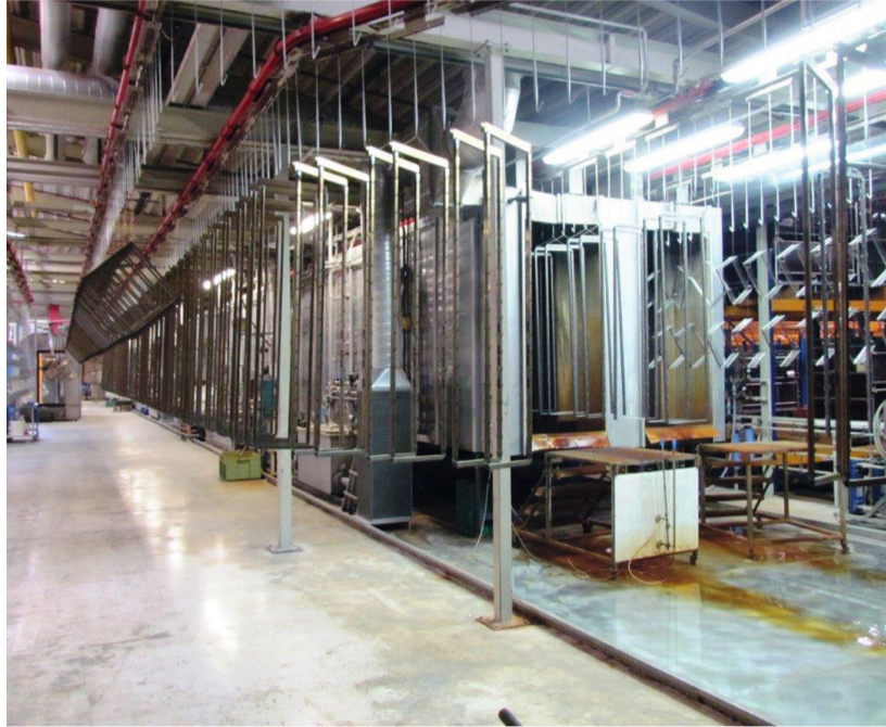
Blick in die Vorbehandlungsanlage bei Kesseböhmer: Die Vorteile des optimierten Vorbehandlungsprozesses sind verbesserte Lackhaftung, geringerer Schlamm- anfall und Energie sparende Arbeitstemperatur.
