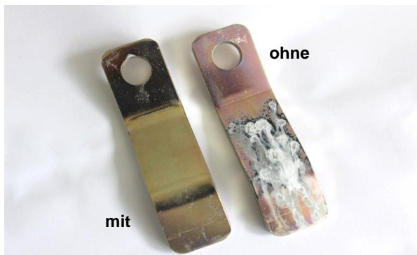
TOPAS 3100 + PROSEAL XZ 111 (+ PROSEAL Nanoadditiv) + SURFASEAL WL 150 nach 840 h im DIN EN ISO 9227
