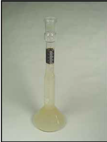
Abbildung 10: Bestimmung der Ölkonzentration durch Säurespaltung
