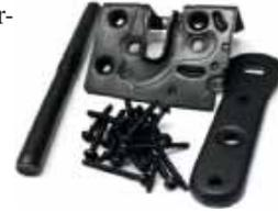
Abb. 4: Schwarzpassivierung auf verschiedenen Bauteilen
