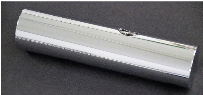
Abbildung 1: Mit dem Saphir 2000 BL beschichtetes Musterteil.
