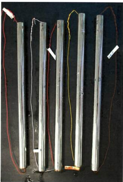
Mit dem Chrom(III)-Verfahren beschichtete und passivierte Stahlrohre nach 216 Stunden im Salzsprühstest (DIN EN ISO 9227).
