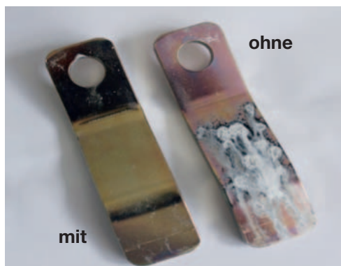
TOPAS 3100 + PROSEAL XZ 111 (+ PROSEAL Nanoadditiv) + SURFASEAL WL 150 nach 840 h im DIN EN ISO 9227
