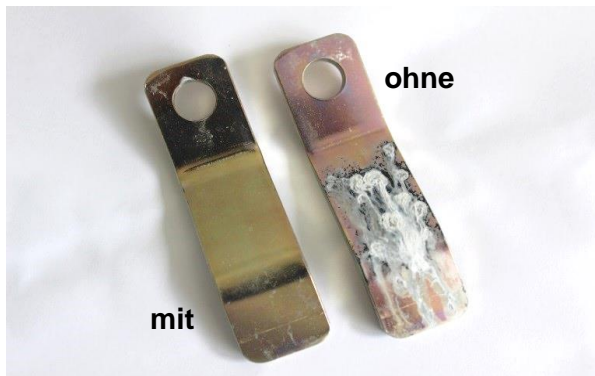
TOPAS 3100 + PROSEAL XZ 111 (+ PROSEAL Nanoadditiv) + SURFASEAL WL 150 nach 840 h im DIN EN ISO 9227
