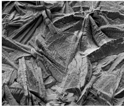
SURFACOTE 333/334, 1000fache Vergrößerung
